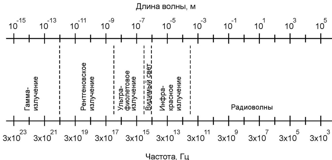
Рисунок 7 – Шкала электромагнитных волн [39]
